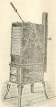
Сл. 12. — Мала суншница са пехом од високог гвозђа за сушење воћа и поврћа. (Веркхофер)
