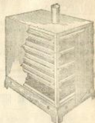
Сл. 9. — Сушница воћа и поврћа без пећи за загревање.
