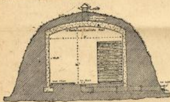
Сл. 1. Трап под земљом за чување јабука. У дву доприра вез на довођење свежег спољњег ваздуха. При врху кроз земљу пролази одушна — вентилатор — за излажење унутрањег ваздуха.
