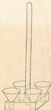
Сл. 3. Справца за ручно сејање кукуруза на кућице са размакнутим зрнима. (Harteley)
