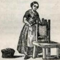
Фабрика земљодјелска и покућни стројева Шнајтлер и Андреја у Берлину, произвела је машину једну, која врло лепо и танко љушти кромпир, јабуке, келербу и т. д. Ова је машина сваком већем домоводству нуждна, јер време љуштењем уштеди.
